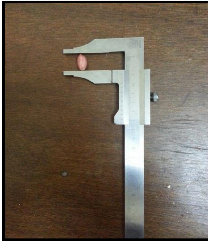
الوثيقة رقم (01): توضيح قياس البذرة باستعمال القدم القنوية
