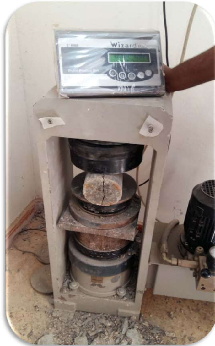
Figure IV. 5: L'essai de traction par fendage des éprouvettes cylindriques.
