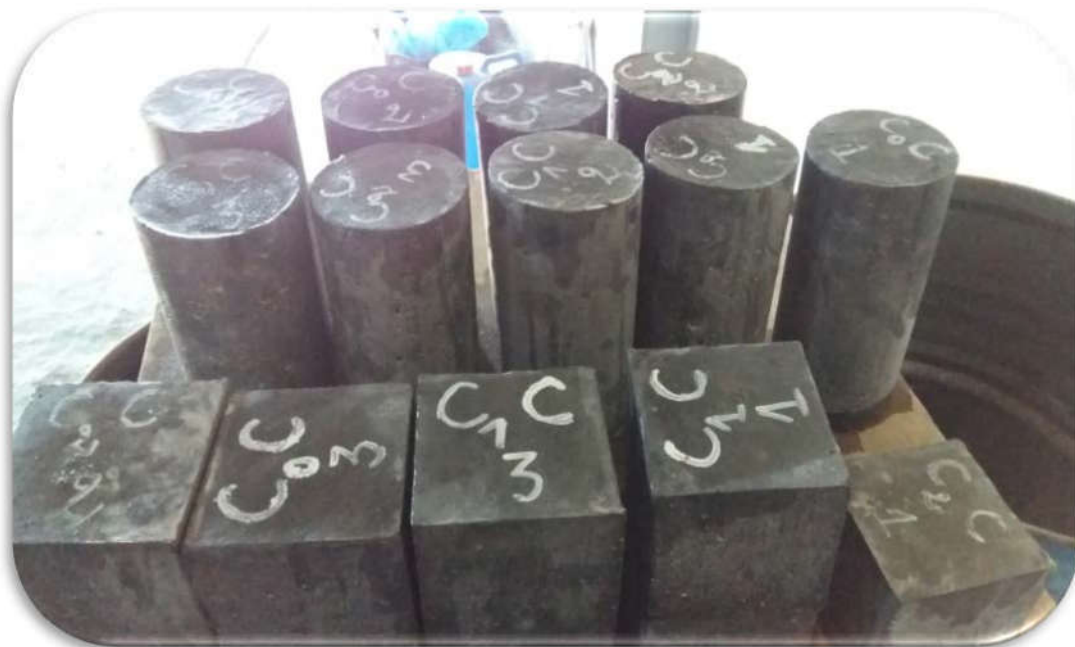
Figure IV .1 : photo des éprouvettes de Béton
