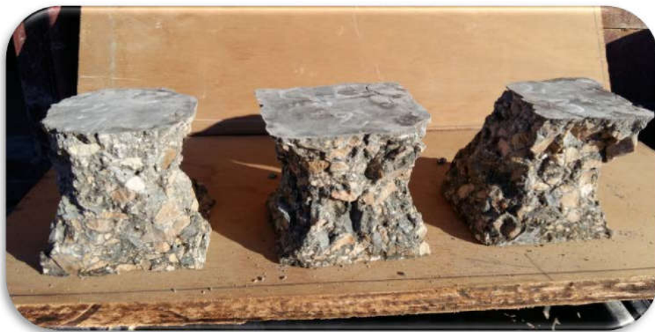
Figure IV. 3: Forme des éprouvettes cubiques après l'essai de compression
