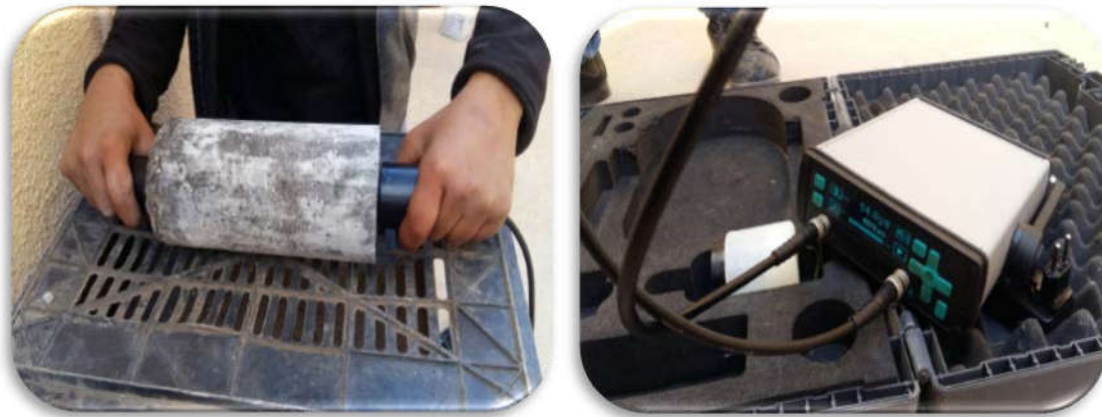
Figure IV.7: photos de l'essai ultrasonique sur l'éprouvette cylindrique 11x22 cm .
