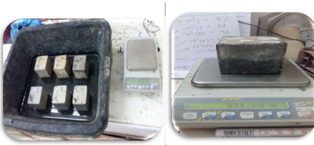
Figure IV. 6: Photos de l'essai d'absorption par capillarité [17]
