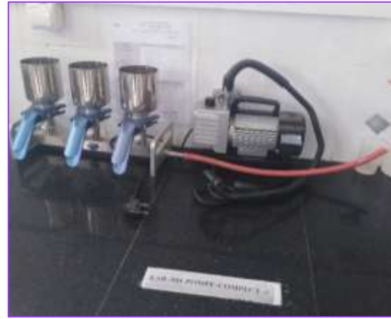
Photo (IV.10): Ensemble de filtration
