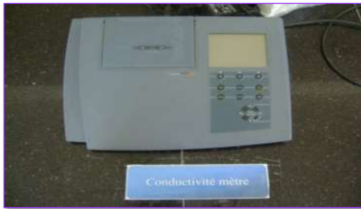
Photo (IV.12): Conductimètre (Terminal 740).
