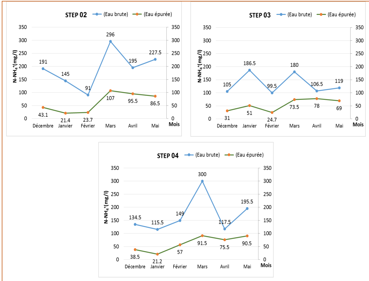
Figure 35 : variations des moyennes mensuelles de l'azote ammoniacal dans les eaux usées brutes et épurées des stations
