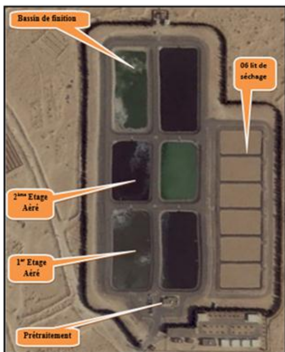
Figure 11 : Plan générale de la station d'épuration.
