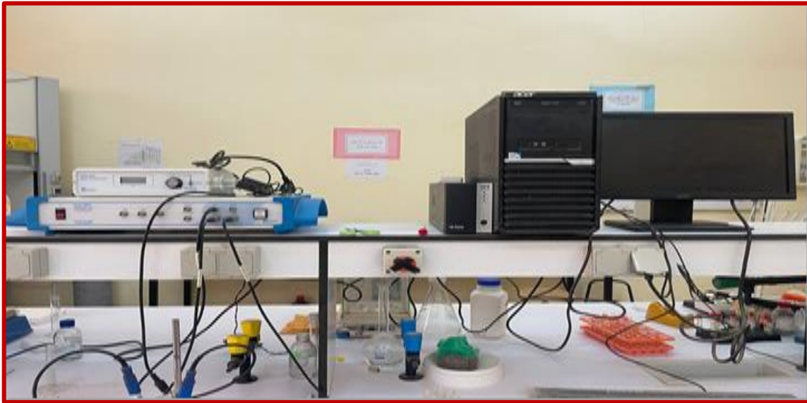
الصورة (5.II): صورة لجهاز Volta Lab PG 301 موصول بجهاز الكمبيوتر
