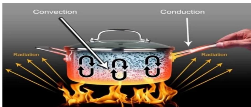
Figure III.3: Exemple sur les trois modes de transfert de chaleur. [22]
