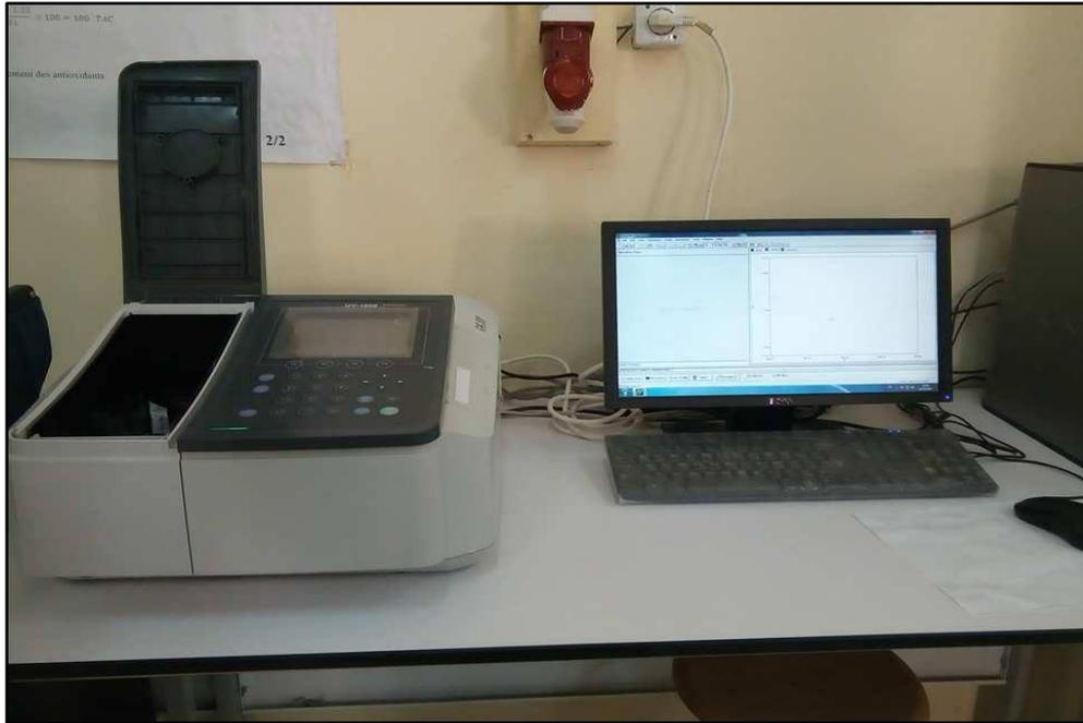
**Figure (III.7):** Spectrophotomètre UV1800.
