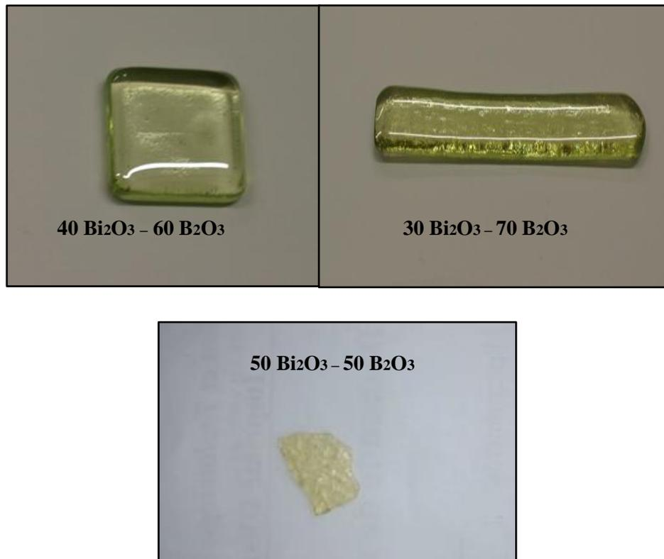
**Figure (III-2) :** Photographie des verres non-dopés du système  $(50+x)\text{B}_2\text{O}_3-(50-x)\text{Bi}_2\text{O}_3$  ( $x=0, 10,20$ )
