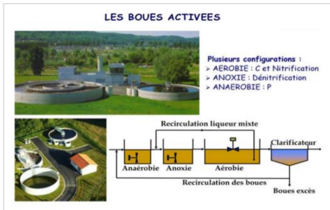
Figure 08. Configuration classique des boues activées (Veolia Eau, 2008, modifiée)
