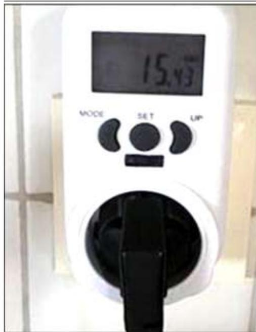
Figure I.16: Un consomètre. [15]
