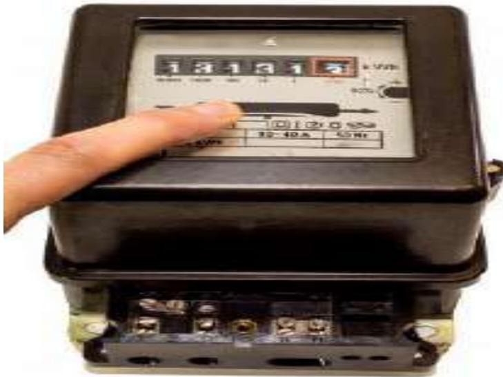
Figure I.1: Compteur électromécanique
