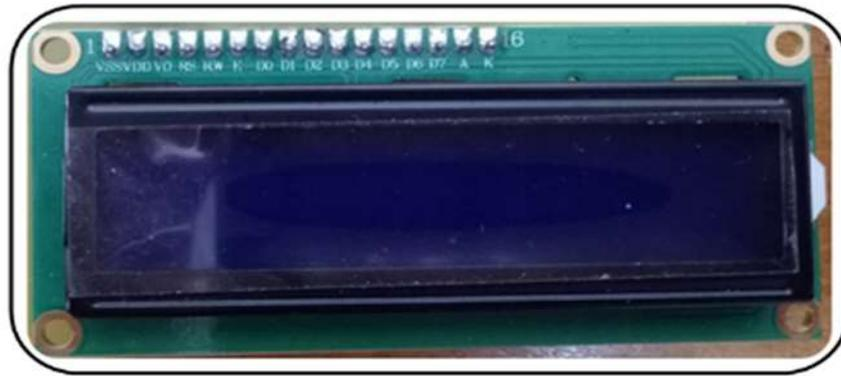
Figure II.16: Afficheur LCD alphanumérique 2 × 16.
