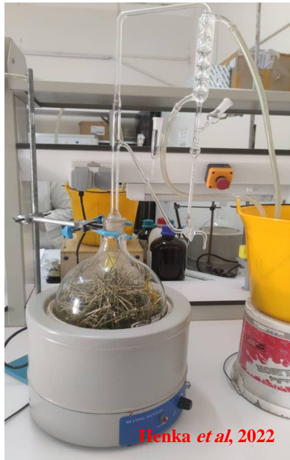
Figure 18 : Extraction d'huile essentielle par hydrodistillation.
