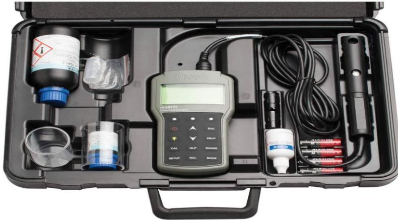
الوثيقة(09): جهاز متعدد القياسات ( Multiparametres )
