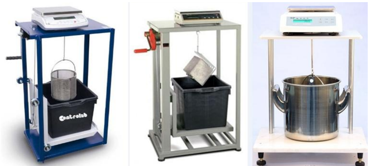
Photo II.18: Types d'appareillages de pesée hydrostatique
