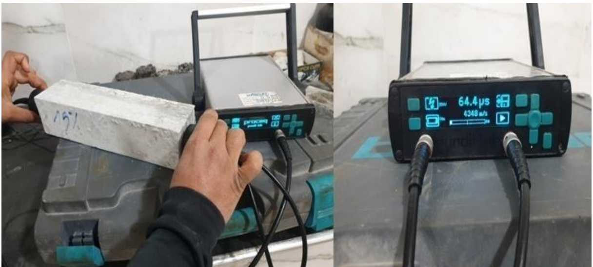
Photo II.16: Appareil à ultrasons (Proceq Pundit Lab)
