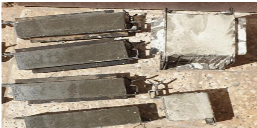
Photo II.11 Moules cubiques et prismatiques
