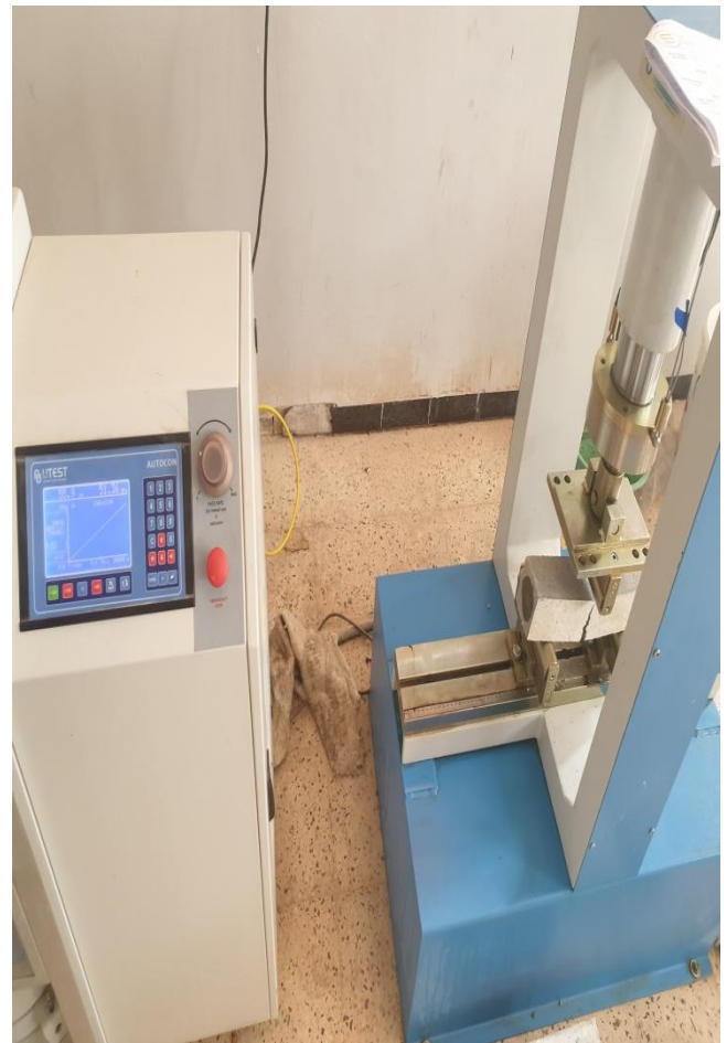
Photo II.15: Appareillage de la flexion
