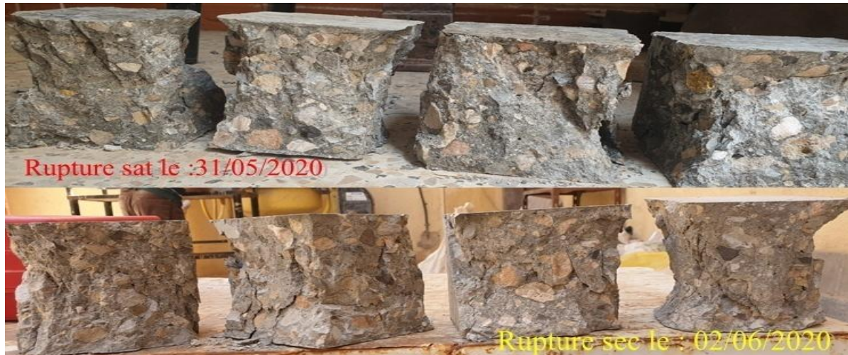
Photo III.1 Exemple de rupture à l’état saturé et à l’état sèche
