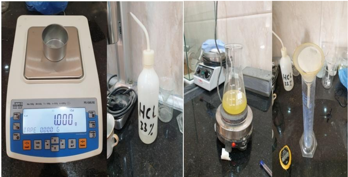
Photo II.6: Appareillage d'essais des insolubles
