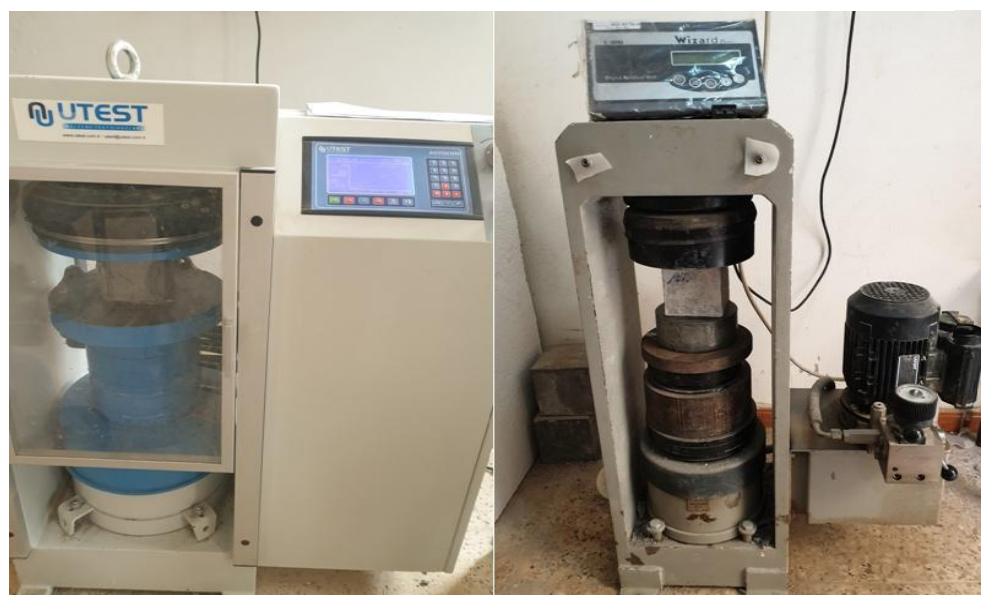
Photo II.14: Deux (02) Appareillages de la compression
