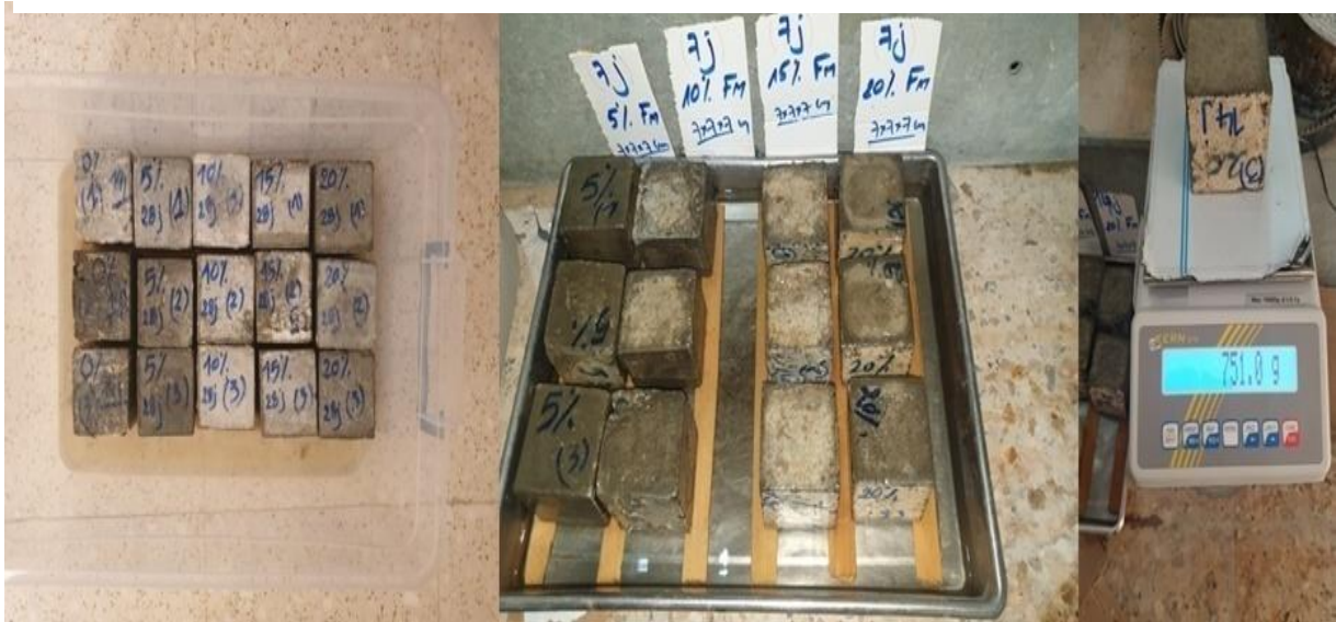
Photo II.17: L'essai d'absorption par capillarité
