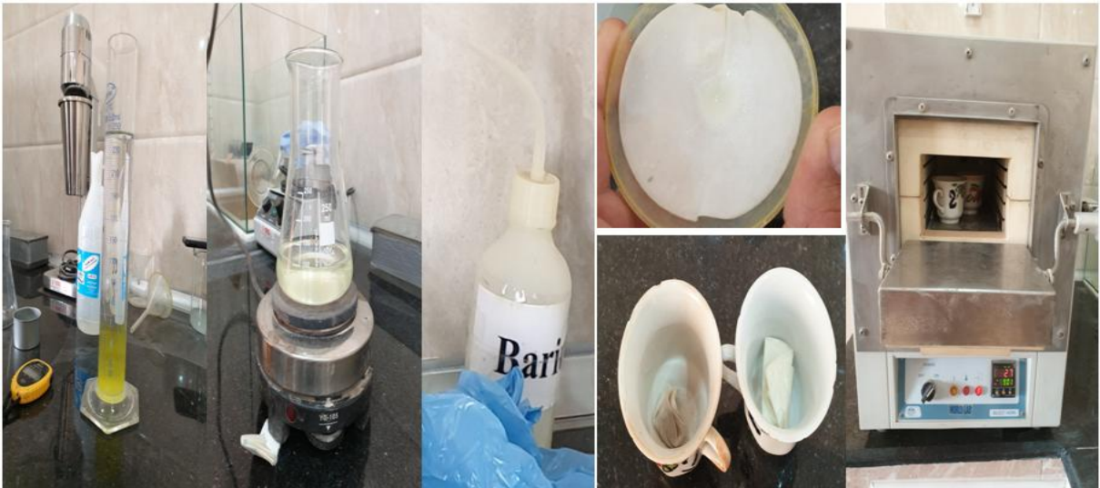
Photo II.7: Appareillage d'essais de teneur en sulfate
