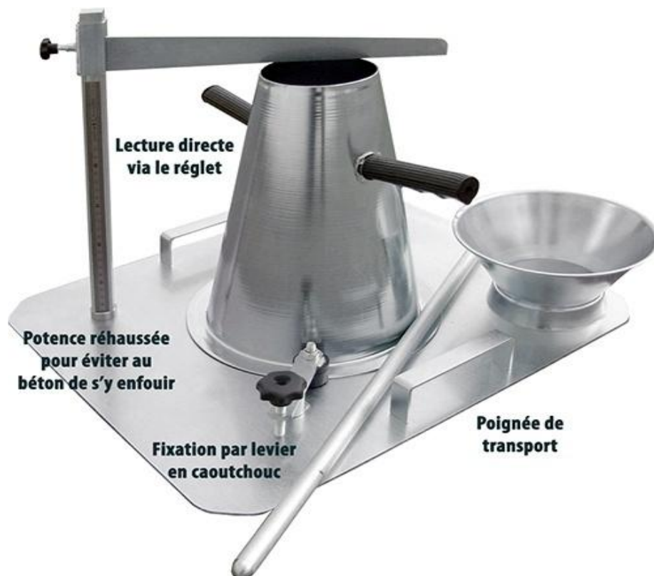
Photo II.13 : Appareillage de cône d'Abrams
